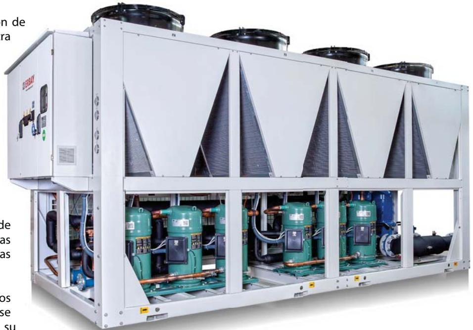
**Compresor de refrigeración:** Los compresores de scroll hermético se utilizan entre 1 y 6 piezas según su capacidad, y los compresores se utilizan en cada circuito de refrigerante independiente como uno, dos o tres. Los compresores utilizados en configuraciones tándem y triples se instalan sobre sólidos railes del bastidor para minimizar los efectos de las vibraciones. Al adoptar un sistema de igualación de aceite, los compresores reciben una distribución equitativa de aceite.
