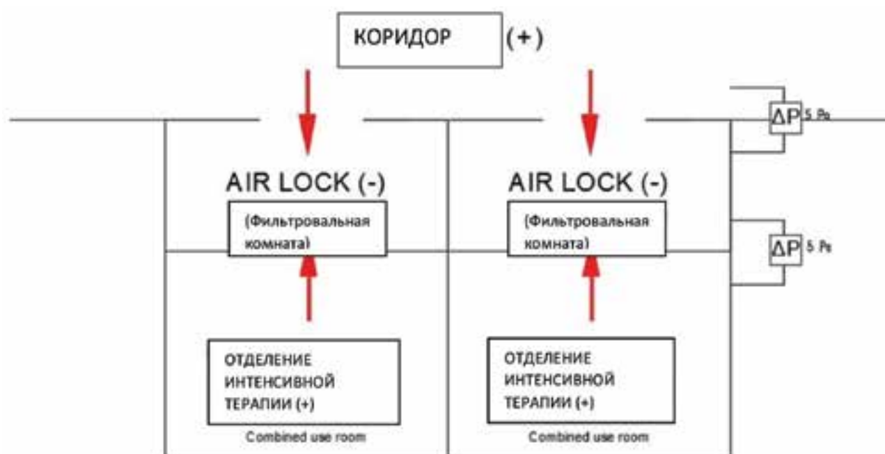
Рисунок 1. Воздушный поток в палатах интенсивной терапии комбинированного типа в период пандемии
