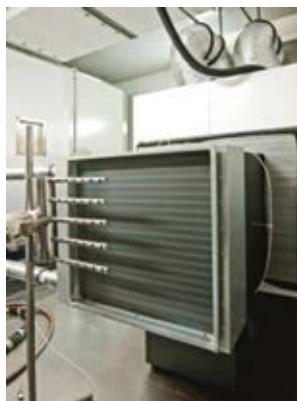
Friterm test setup for heat exchanger tests acc. to ASHRAE standard 33-2000 Условия проведения испытаний для теплообменника Friterm в соотв. со стандартом ASHRAE 33-2000
